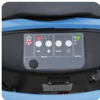
Pannello comandi analogico, semplice ed intuitivo. Interruttore generale ON/OFF e interruttore a chiave, interruttore per motore spazzola e aspirazione. Disgiuntore termico per proteggere il motore spazzole e aspirazione, indicatore livello batteria, contaore.
