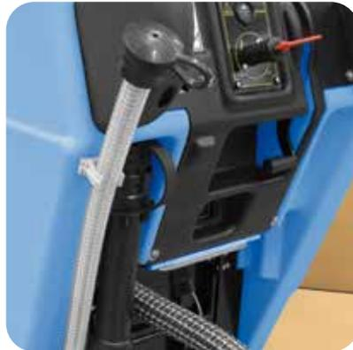
Sistema automatico dosaggio detergente. Accesso rapido al serbatoio di recupero, facilmente ispezionabile. Accesso rapido e veloce manutenzione dei componenti senza ausilio di attrezzi.
