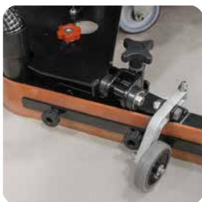
Il resistente tergipavimento a V assicura un'asciugatura perfetta su ogni tipo di pavimento, anche se con fughe larghe. Le ruote antitraccia evitano di lasciare segni dopo l'asciugatura. Completamente adattabile ad ogni superficie.
