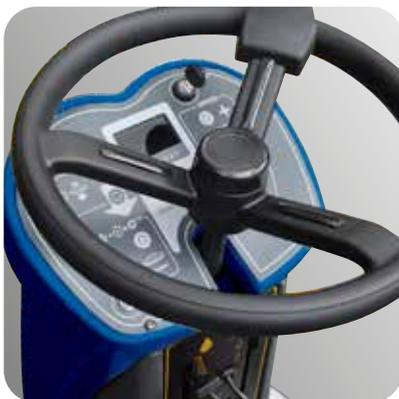
vuoto e indicatore di trazione in avanti/indietro. Regolazione della velocità, clacson, interruttore del motore di aspirazione con ritardo di spegnimento. La seduta confortevole ed ergonomica assicura comodità per lungo tempo all'operatore, aumentando la produttività del lavoro.
