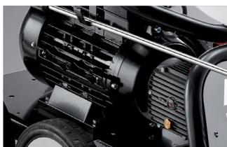
Motore elettrico industriale a 4 poli ampiamente sovradimensionato, protetto da verniciatura e dotato di giunto elastico per un migliore accoppiamento motore/pompa
