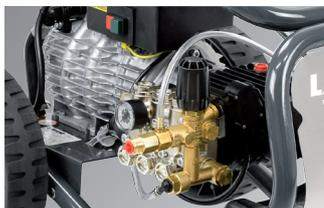
Nuove pompe CL3.8 e CL 6.0 autoadescenti a tre pistoni in ceramica integrale, doppio visore olio e testata in ottone. Nuova valvola di regolazione pressione flangiata L3.1, passaggi interni ridimensionati per garantirne il corretto funzionamento anche in condizioni di alte portate d'esercizio
