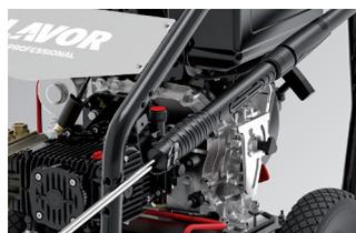
Motore Diesel Yanmar L100V, quadro avviamento elettrico con spie di controllo, deceleratore automatico di giri
