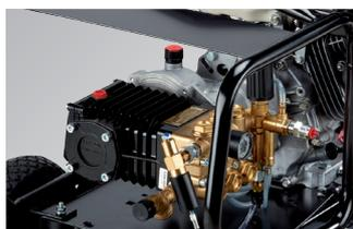
Nuova pompa CL 6.0 autoadescente a tre pistoni in ceramica integrale, doppio visore olio e testata in ottone. Riduttore di giri tra motore e pompa. Nuova valvola di regolazione pressione flangiata L3.1, passaggi interni ridimensionati per garantirne il corretto funzionamento anche in condizioni di alte portate d'esercizio
