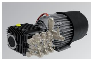
Nuova pompa CL 6.0 autoadescente a tre pistoni in ceramica integrale, cuscinetti a rulli conici, doppio visore olio, testata in ottone nichelato e guarnizioni acqua per alte temperature
