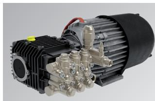
Motopompa professionale con motore 4 poli (1400 rpm) e pompa lineare autoadescente: la bassa velocità di rotazione allunga sensibilmente la vita dei componenti interni alla motopompa, garantendone una maggiore efficienza e silenziosità
