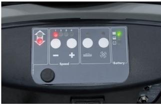
Pannello comandi intuitivo. Selettori di regolazione della velocità. Interruttore generale ON/OFF e interruttore a chiave, interruttore spazzola e aspirazione. Disgiuntore termico per proteggere il motore aspirazione e motore spazzole, indicatore livello batteria, contatore.
