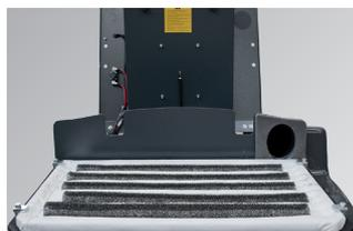
Filtro a tasche in poliestere con scuotifiltro elettrico di serie. Controllo delle polveri tramite il sistema di filtraggio
