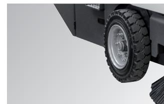
Spazzole centrali di grandi dimensioni. Sterzo con idroguida sulla ruota posteriore
