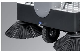
Impianto idrico frontale per abbattimento polveri con serbatoio posteriore da 2lt
