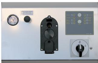
Pannello comandi semplice ed intuitivo, aggancio rapido pistola vapore, interruttore generale ON/OFF con spia luminosa, spia luminosa attivazione resistenza caldaia, regolatore portata vapore, spia segnalazione vapore pronto, manometro vapore.
