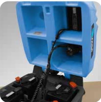
Il carica batterie e il motore di aspirazione sono posizionati sotto il serbatoio di recupero; l'alloggiamento del motore di aspirazione consente di ridurre drasticamente la rumorosità durante l'utilizzo. La seduta confortevole ed ergonomica assicura comodità per lungo tempo all'operatore, aumentando la produttività del lavoro.
