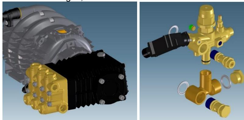
**Installare la valvola sulla pompa, serrando le viti con una coppia consigliata di 35 Nm**
