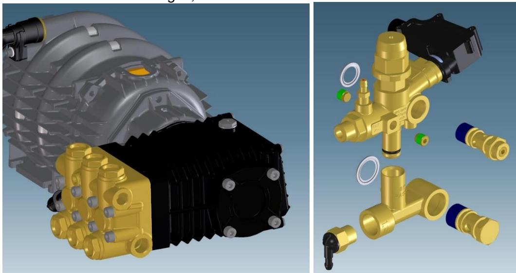
**Installare la valvola sulla pompa, serrando le viti con una coppia consigliata di 35 Nm**
