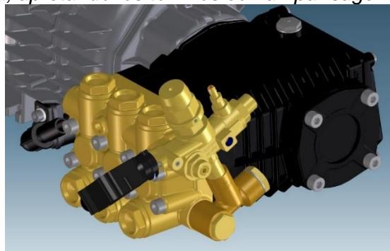
**Installare la valvola di sicurezza sulla valvola di regolazione L3.1, utilizzando Loctite 243**
