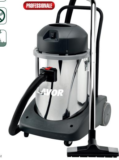
• Motore bistadio silenziato • Sistema aspirante con raffreddamento by-pass • Fusto in acciaio inox • Ganci di chiusura professionali • Sistema antielettrostaticità • Tubo di scarico serbatoio • Carrello antiurto • Valvola a galleggiante • Filtro panno • Cavo di alimentazione 10 m • Appoggio della testata antiribaltamento (utile durante la pulizia del filtro) • Ruote antitraccia • Accessori Ø 40
