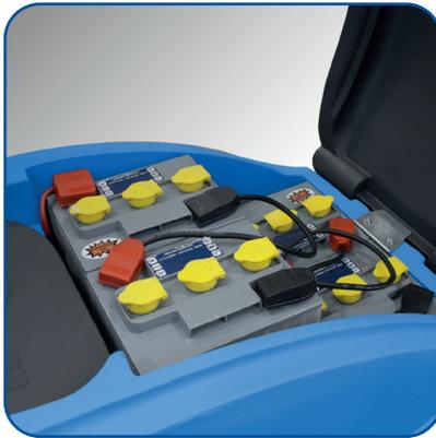
Accesso rapido al vano batterie e motore aspirazione senza l'ausilio di strumenti. Serbatoio in polietilene ad alta resistenza, di grande capacità, evita frequenti soste per il riempimento. 4 batterie x 6 V-180 Ah C5 che garantiscono grande autonomia di lavoro.
