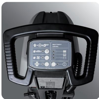
Interruttore ON/OFF che previene accensioni accidentali. Protezione contro sovraccarichi, eccessiva scarica delle batterie (modelli a batteria) e utilizzo accidentale. Pratico comando per sgancio/manutenzione spazzola. Impostazione Eco Energy per utilizzo prolungato e funzionamento estremamente silenzioso (modelli a batteria).
